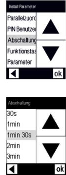
Erfolgt eine Zeitlang keine Aktion, die die Video-Innenstation aktiviert (z. B. ein eingehender Türruf oder Drücken der Funktionstaste) wird das Display abgeschaltet.
